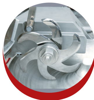
Couteaux réglés à 1 mm de la cuve
